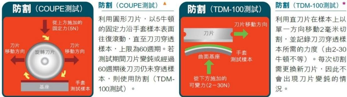
圖一、COUPE 測試跟 TDM-100 測試
