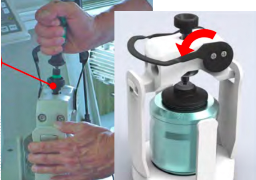
Classic系列的扭力板手與上下皆有墊片的安全夾具，確保每位使用者皆能安全使用設備
